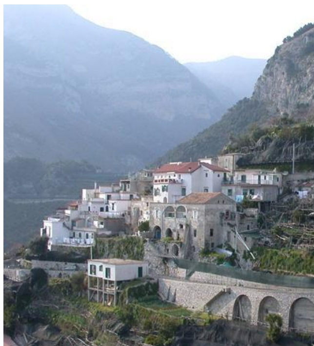
Fig. 3.21 - Gli effetti delle norme di tutela quantitative. La casa su travi e pilastri è perfettamente conforme alle norme del piano urbanistico, poiché il “volume” computabile è solo quello chiuso. Ma l'impatto sul paesaggio non è migliorativo.
