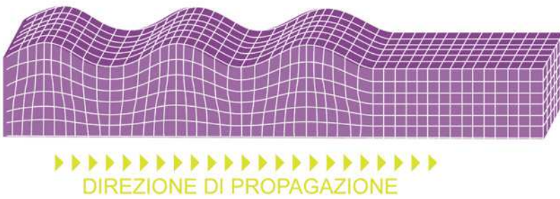
Fig. 7 Onda superficiale di Rayleigh. Il moto nel mezzo descrive traiettorie ellittiche retrograde che avvanzano nella direzione di propagazione dell'onda (da INGV).
