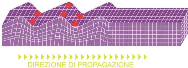
Fig. 8 Onde superficiali di Love. Sono onde che si propagano nel piano orizzontale. Il moto nel mezzo è trasversale alla direzione di propagazione dell'onda (da INGV)
