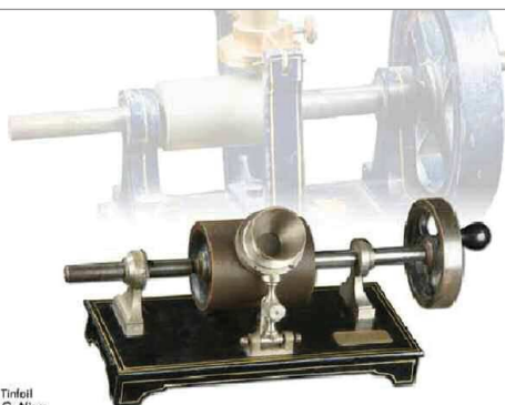
Tinelli G. Nigra Torino, Italia 1879 c. Una delle prime macchine per l'incisione e la riproduzione fabbricate in Italia (1879 circa). La base metallica verniciata di nero e decorata con filigrane dorate misura circa 15 centimetri di larghezza e 30 di lunghezza. Una delle caratteristiche tecniche su bita applicate ai fonografi Tinelli è un avanzamento a rettilineo come si vede sul lato sinistro del supporto del mandrino. Quando la vite di sicurezza è disinnestata il complesso del mandrino può essere subito rimesso nella posizione di avviamento. La fessura nel mandrino serve per il fissaggio del foglio di stagno che viene così avvolto al mandrino e sul quale, tramite il diaframma, prima si incide e poi si riproduce la voce.
