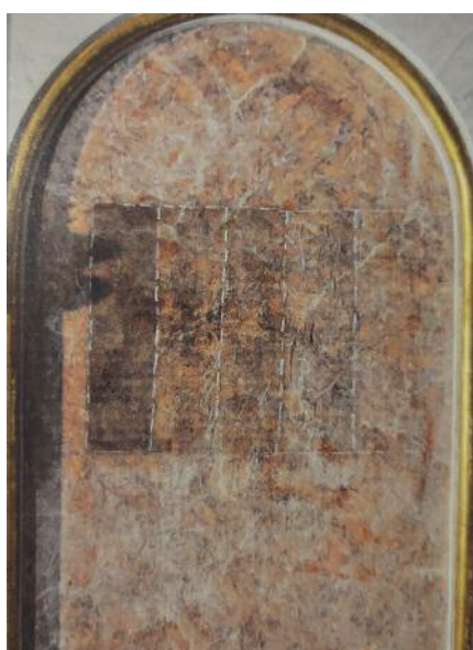
Fig. 15 Tassello stratigrafico definente vari gradi di pulitura.
