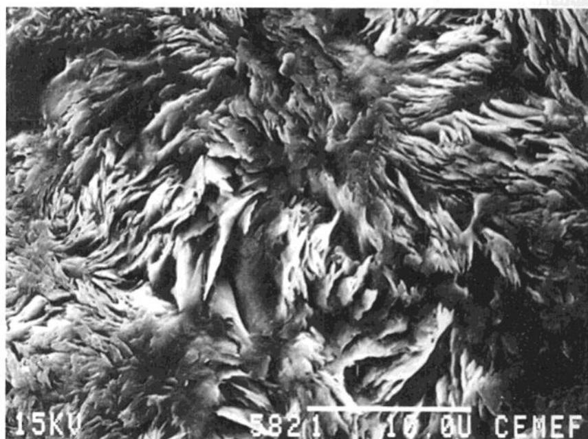
Fig. 2. Organisation interne des lamelles cristallines à l'intérieur d'un grain de glauconie évoluée. MEB. La barre représente 10  $\mu\text{m}$ .
